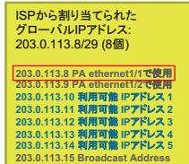
内部ネットワークのクライアントがインターネットに通信する際、送信元IPアドレスはPAのethernet1/1に割り当てられたIPアドレスにNAT変換される
